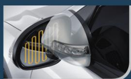
RETROVISORES EXTERNOS COM REBATIMENTO ELÉTRICO E ANTIEMBAÇANTE. RETROVISOR INTERNO ELETROCRÔNICO. KEYLESS PARA ABERTURA E FECHAMENTO DAS PORTAS E DO PORTA-MALAS.
