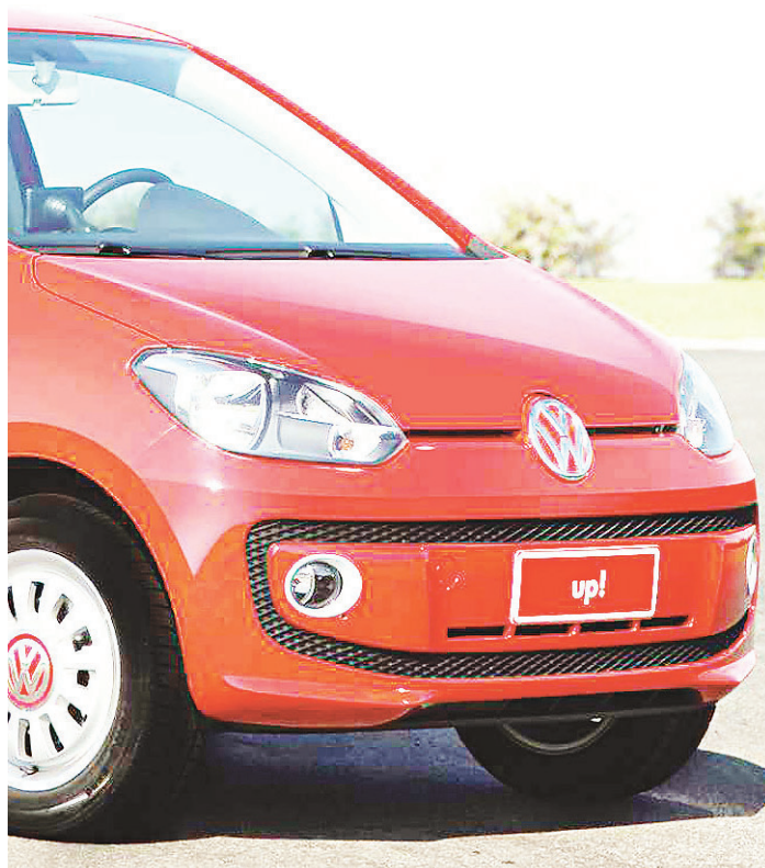
// Capô inclinado, resultou em uma cabine maior para o UP!
