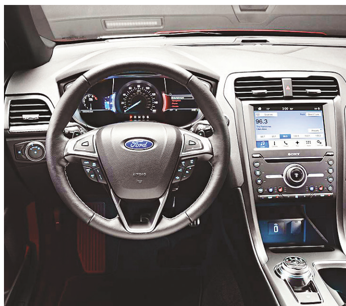
// Automático: alavanca de câmbio foi substituída por um botão
