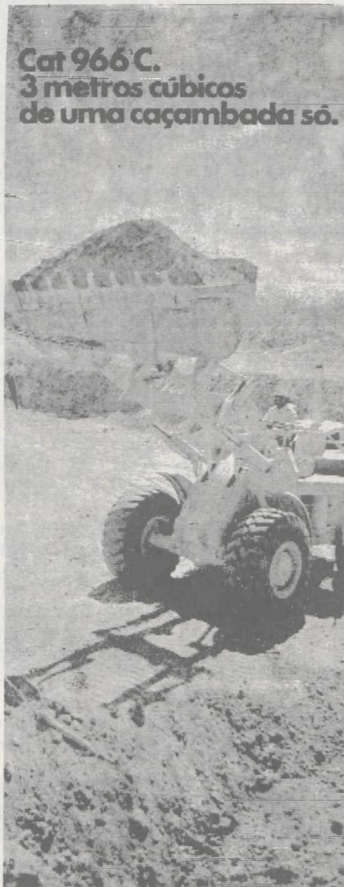
À rapidez de ciclo, a Cat 966C junta a grande capacidade da caçamba: 3,06 m<sup>3</sup>, que lhe permite carregar qualquer basculante com poucas caçambadas.
