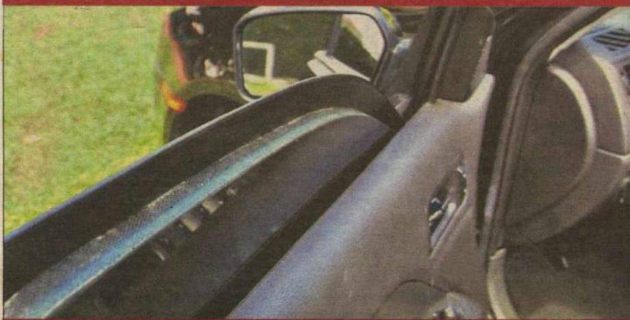
Blindagem fica visível ao baixar os vidros, que são mais grossos que o convencional
