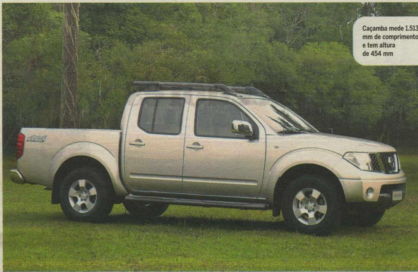
Caçamba mede 1.513 mm de comprimento e tem altura de 454 mm
