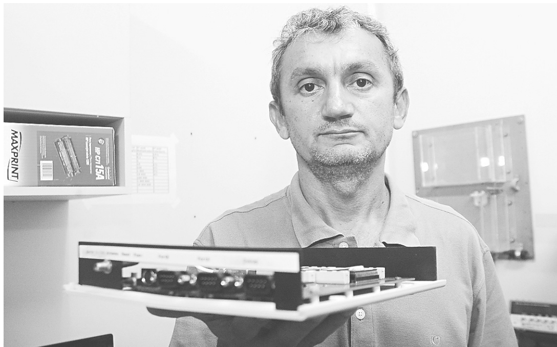
► Protótipo do GPS mede 14x5x6 cm e pesa 0,5kg
